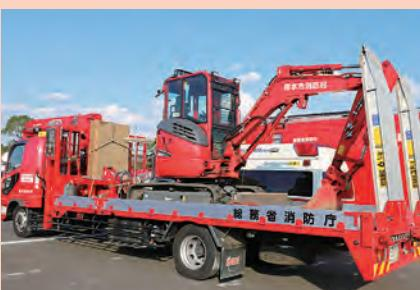
▲土砂を除去するための小型重機
